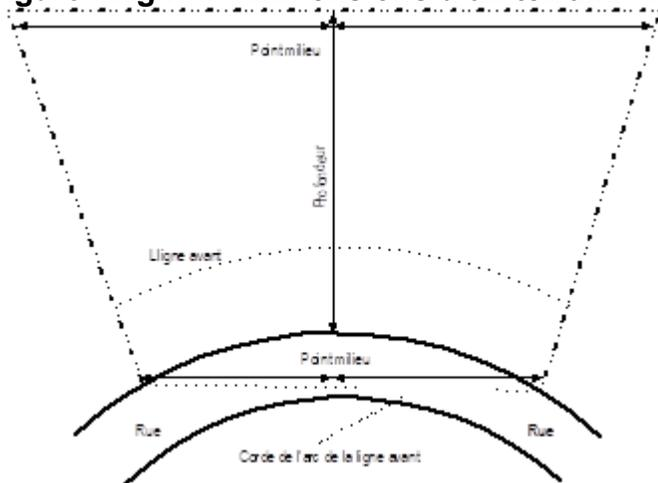
**Figure 4.1h : Dimensions d'un terrain – Enclavé**
