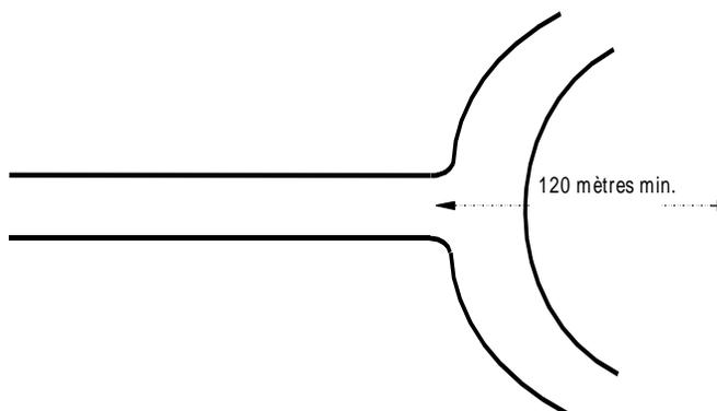
**Figure 5.6d : Rayon de courbe minimal à proximité d'une intersection**
